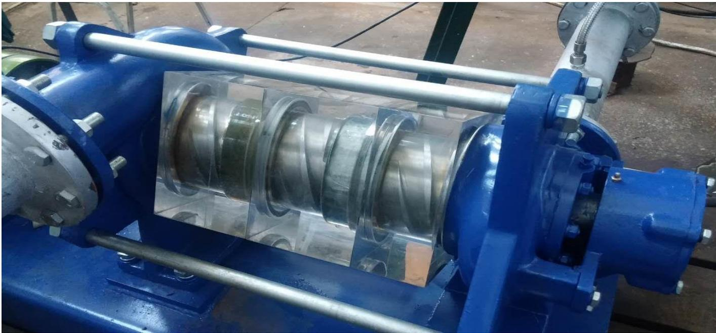
研制的供试叶片式气液多相混输泵
